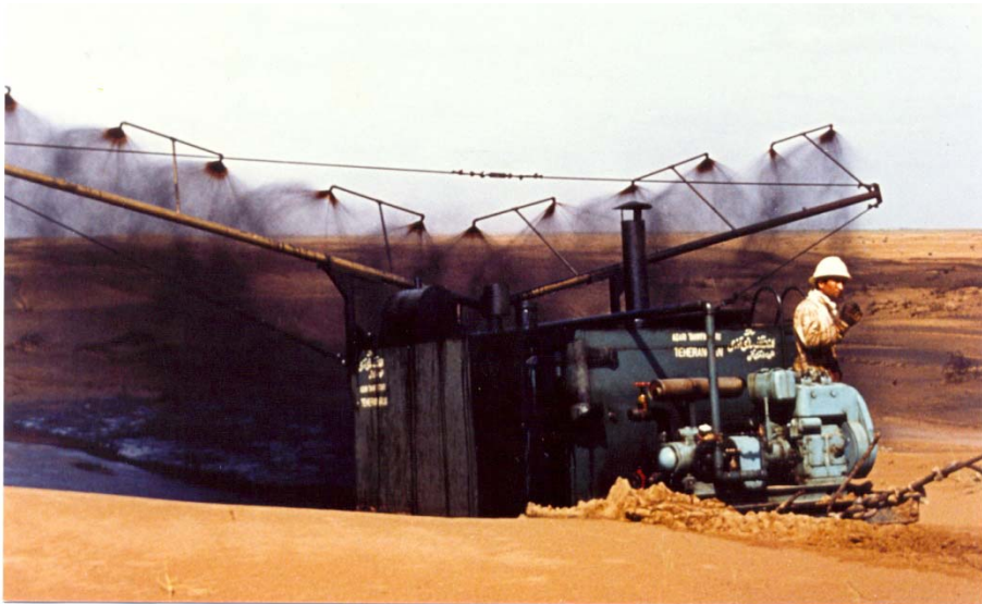
شکل شماره ۹-۲- اسکی مجهز به آنتن مالچ‌پاش
