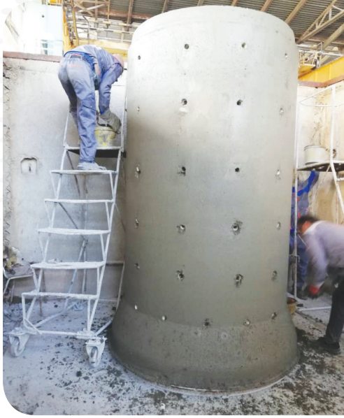
شکل ۳ لوله تهیه شده مربوط به گالری سامانه قنات معکوس
